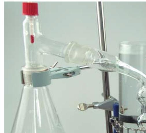
Весь процесс производства органических видов топлива может быть показан с помощью Набора „Биотопливо“. Процесс начинается с биологического этапа спиртового брожения. Затем полученное сусло проходит дистилляцию с помощью охлаждаемого конденсатора, который был специально разработан для этого эксперимента. Последний этап демонстрирует преобразование полученного биотоплива в полезную энергию, такую как электрическая энергия, с использованием этанолового топливного элемента.
